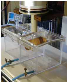
Obr.: Model trupu a časť gradiometra umiestneného nad modelom pečene.
