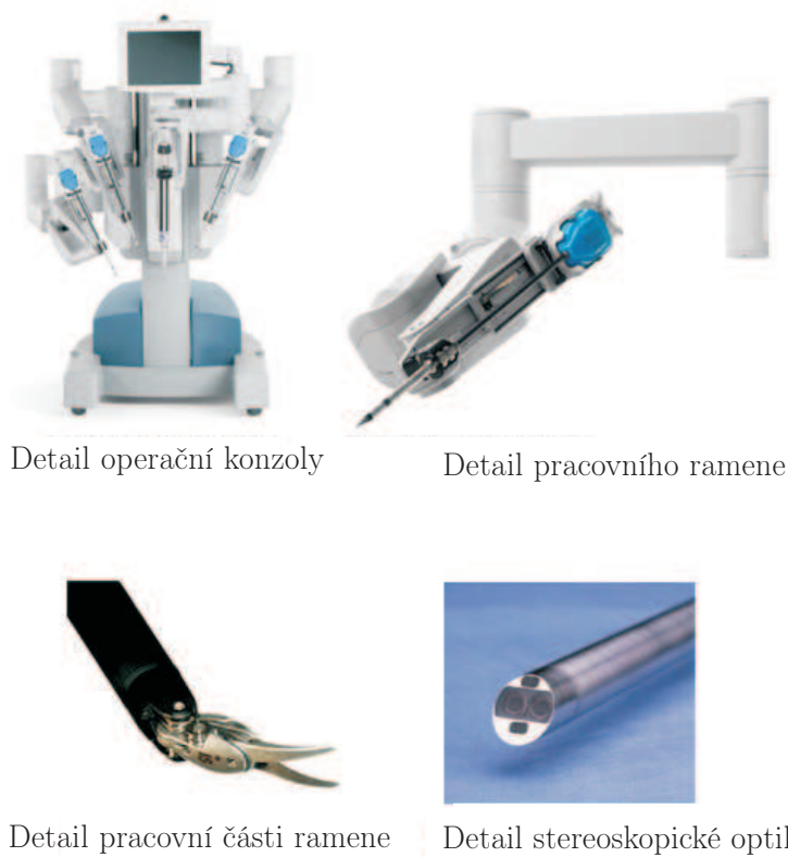
Obr. 6: Robotický systém, který slouží pro chirurgické zákroky [19].
